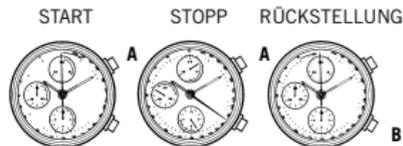
3. Zum Bedienen der Stoppuhr, den Knopf an der 2-Uhr-Position einmal drücken. Der Sekundenzähler fängt an, die Zeit zu messen. Zum Stoppen der Stoppuhr, den Knopf an der 4-Uhr-Position noch einmal drücken.
