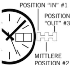
2. Zur Schnelleinstellung des Kalenders die Krone in Position #2 ziehen. Der Sekundenzeiger läuft hierbei weiter. Die Krone in eine Richtung drehen, um das korrekte Datum einzustellen. Die Krone in die entgegengesetzte Richtung drehen, wenn Ihre Uhr eine
